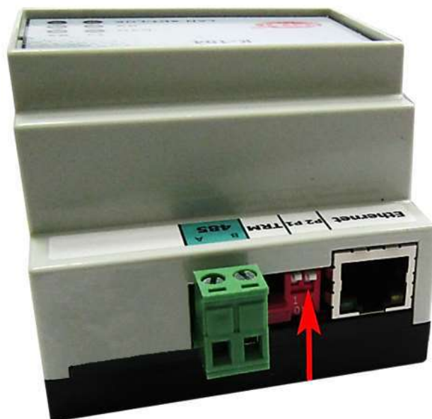
Рисунок 36 – Перевод движковых переключатели в положение OFF
